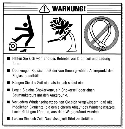
Spulen Sie immer soviel Seil wie möglich ab, lassen Sie jedoch immer 5 Seilwicklungen auf der Trommel. Suchen Sie einen Ankerpunkt aus, der weit genug entfernt ist. Dies ermöglicht der Winde die größte Zugkraft.
